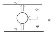
**A.** Calcula la potencia que debe tener el compresor si se realizan 60 ciclos por segundo en la tarea de refrigeración. Para calcular la cantidad de trabajo que debe aportar el compresor utilizamos la expresión:
